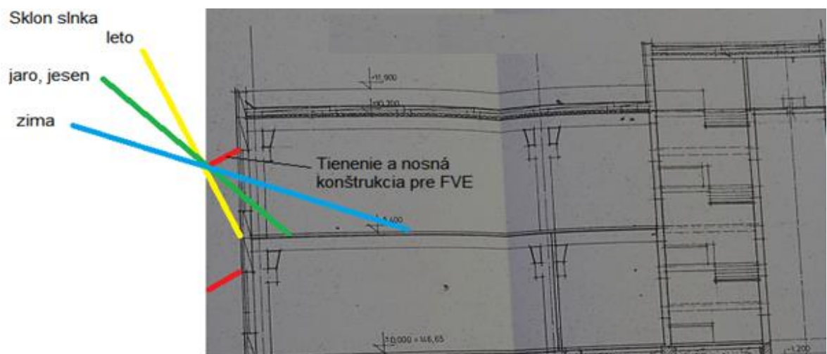
Obrázok 43: Tienenie okien a nosná konštrukcia FVE
